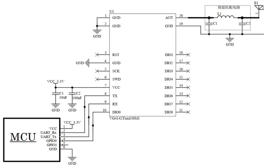
图 5-1 编程开发硬件连接
